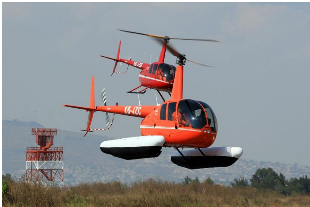
Поплавки на шассе позволяют садиться на воду
